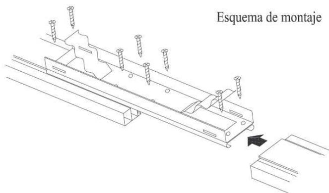
Insertar las dos guias cortadas en la grapa de unión. Utilizar la misma grapa de unión como referencia para hacer los 4 agujeros de sujeción en cada guia de 3,5mm de diametro. Fijar la grapa con los tornillos entregados.
